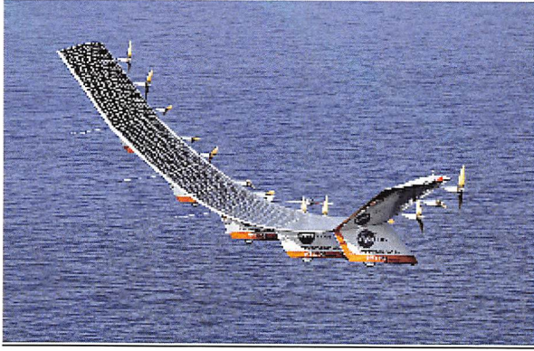
طائرة تعتمد في طيرانها على الكهرباء التي تستمدتها بالكلية من الخلايا الشمسية، بنتها "ناسا" (NASA)
